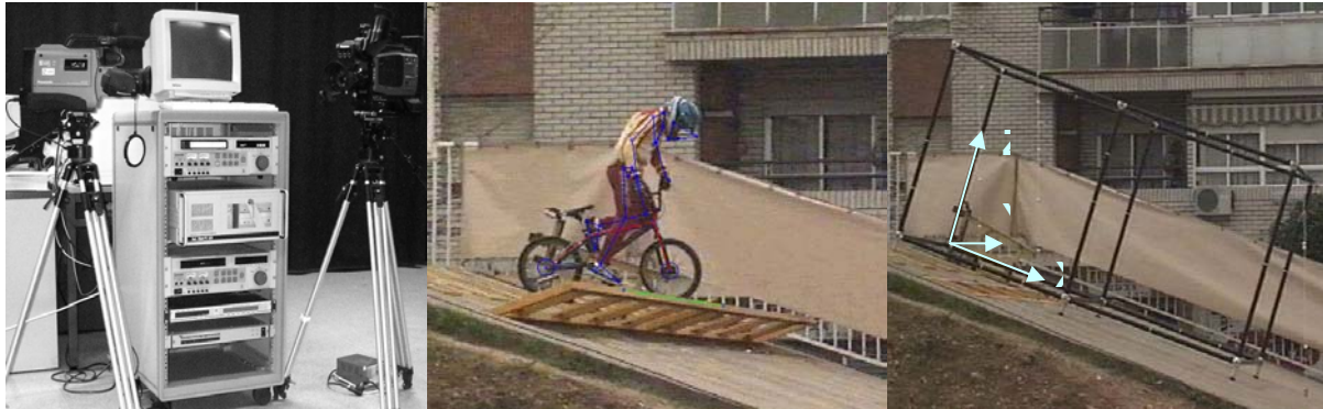
Figura 1. Sistema de fotogrametría video tridimensional. En el sistema de referencia se indican las direcciones X-anteposterior en la dirección de la salida; Y- mediolateral y Z-perpendicular a las otras dos.
